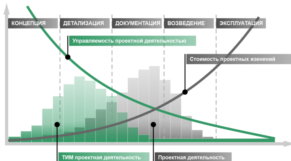
Рис. 1. Эффективность использования ТИМ в строительном проектировании
